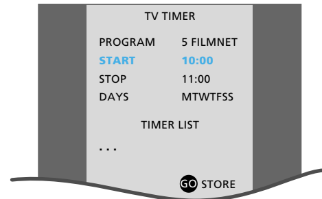
Menu for programmering af en Timer Play (tidsprogrammeret afspilning) for fjernsynet – indtast oplysningerne om Deres Timer-funktion, og når De fastindstiller dem, vil funktionen blive vist i en TIMER LIST (liste over programmerede Timer-funktioner).
